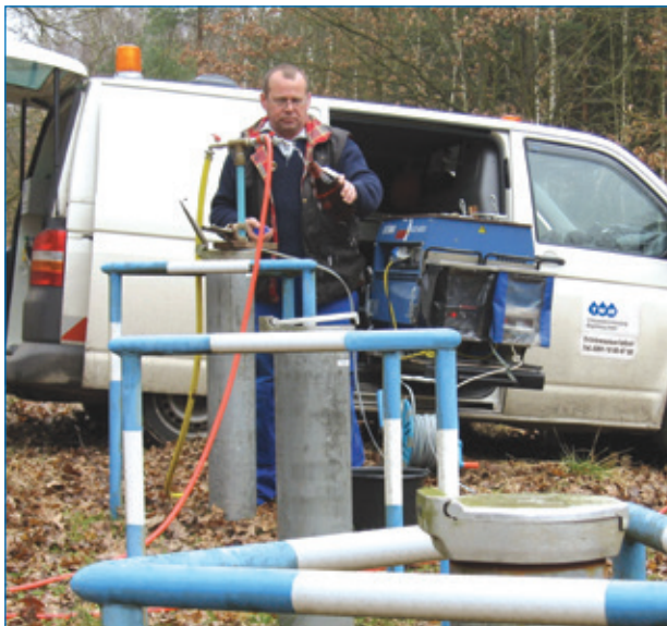
Pegelbeprobung einer Vorfeldmessstelle durch das TWM Trinkwasserlabor
