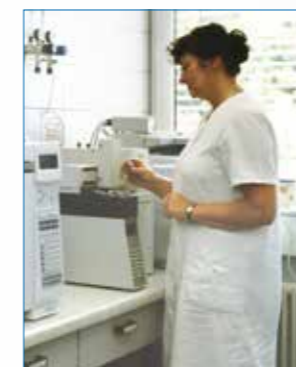
Bestückung des Probensamplers des Gaschromatographs
