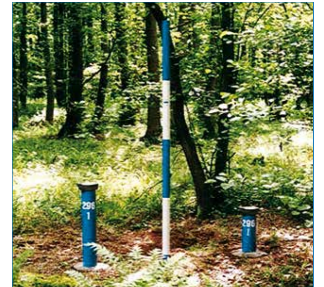
Pegel zur Erfassung der Grundwasserstände und der Beschaffenheit
