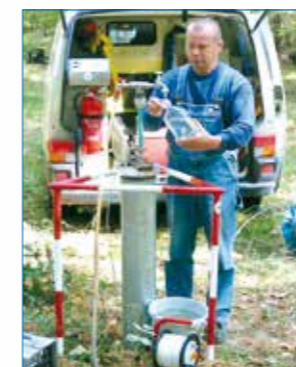
Beprobung einer Vorfeldmessstelle durch das Trinkwasserlabor
