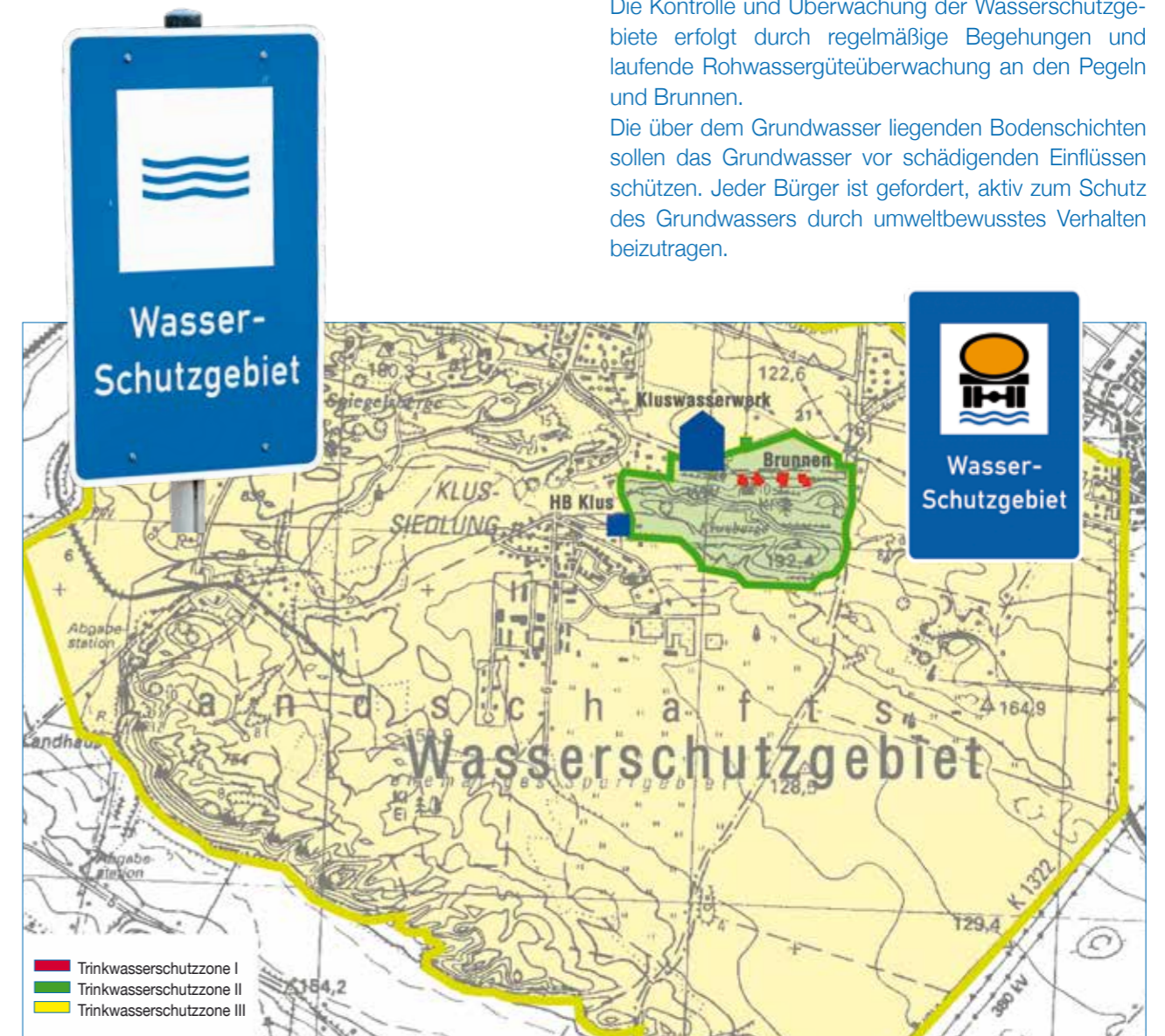
Darstellung der Wasserschutzzonen des Kluswasserwerk
