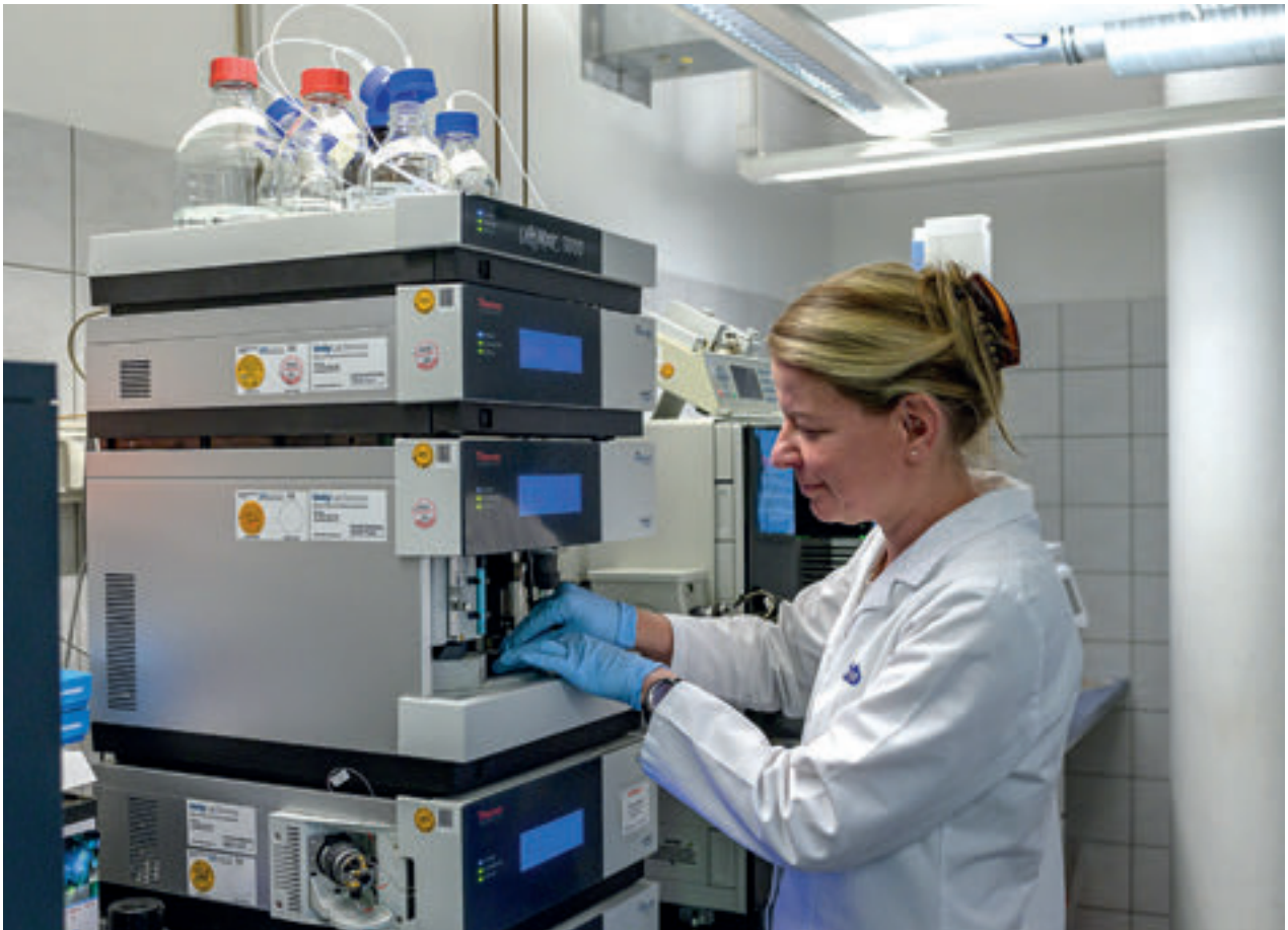
Die Laborantin Karin Ritschl bei der Durchführung von Pestizid-Analytik am modernen Massenspektrometer
