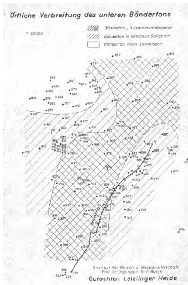
Erkundungsbohrungen geben Aufschluss über die Verbreitung von undurchlässiger Schichten
