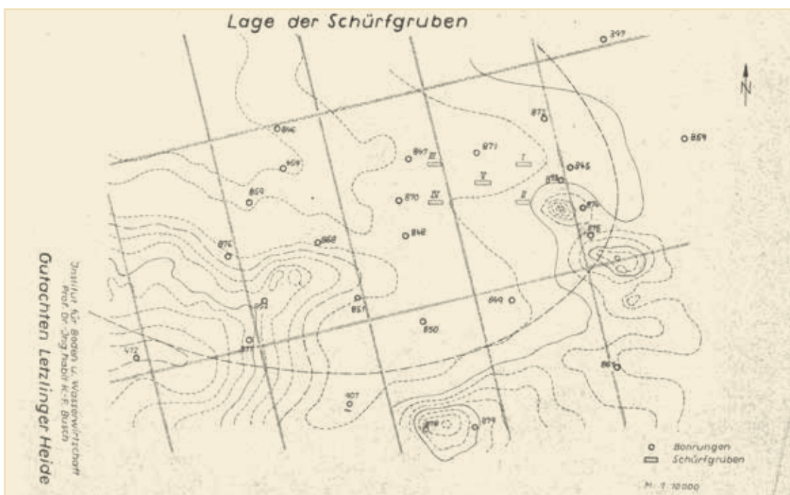
Schürftgruben und Bohrungen geben den Aufschluß über die Bodenverhältnisse
